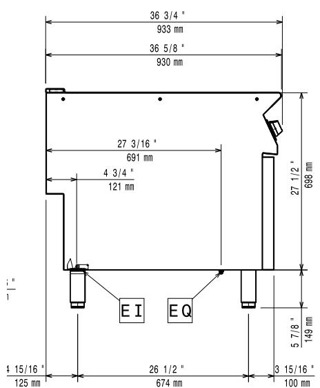
**EI** = Conexión eléctrica (energía)
